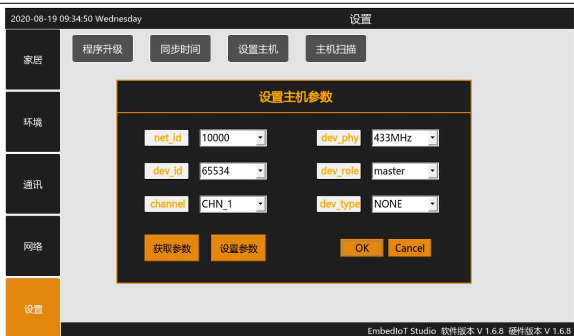
如图所示，点击【设置主机】按钮，弹出设置主机参数界面，可以使用该界面进行参数获取和参数设置，设置完成后，点击 OK 退出界面。【主机扫描】按钮是在从机入网时使用的，点击该按钮，主机会启动扫描，进入待入网状态，等待接收从机的入网请求。
